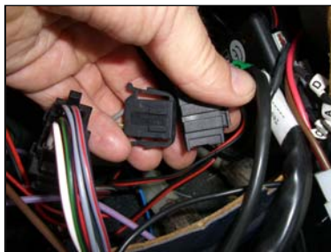
Steckverbindung der Rückleuchten trennen und die Stecker mit dem Kabelsatz verbinden.
