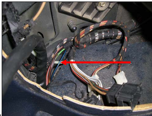
Den Kabelsatz dementsprechend einstecken und rechten Rückleucht anschließen. Im Ablagefach der linken Rückleuchte das Kabel blau/schwarz (Rückfahrcheinwerfer) durchtrennen und wie in der Einbauanleitung beschrieben anschließen.
