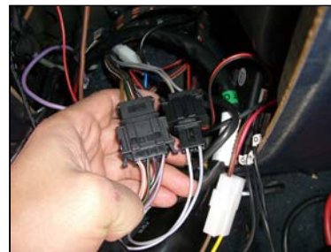
Steckverbindung der Rückleuchten trennen und die Stecker mit dem Kabelsatz verbinden.
