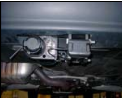
Fahrzeug ohne Kugelkopf, Stoßstangenausschnitt
